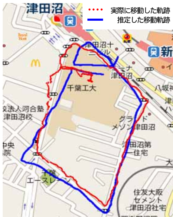
図 - 6 磁気センサのみによる移動軌跡の推定結果
