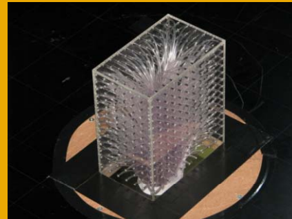
高層ビルのガラス窓に働く風の力を測るための模型（風圧実験用模型）
